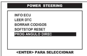
Del menú principal del sistema de la dirección asistida (**POWER STEERING**), pulse en la pantalla del CJ 4 R la opción **PROG ANGULO DIREC** o selecciónela por medio de las teclas <ARRIBA> o <ABAJO> y presione la tecla <ENTER>.
