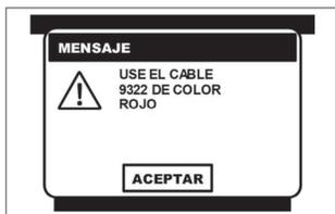
Para **acceder al sistema** del immobilizador, el CJ 4 R solicita el cable **9322 de color rojo**, una vez colocado presione la tecla <ENTER> para continuar.
