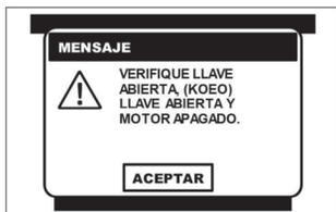
Al seleccionar cualquiera de las **FUNCIONES ESPECIALES**, el CJ 4 R despliega un mensaje, donde se indica que la prueba solo se puede realizar con el conmutador de encendido en la posición de ON y el motor apagado (**KOEO**).
