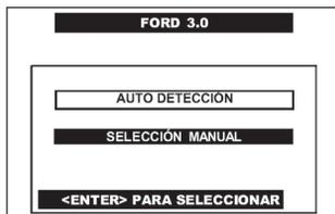
Del menú de **FORD 3.0**, pulse en la pantalla del CJ 4 R la opción de **SELECCION MANUAL** o selecciónela por medio de las teclas <ARRIBA> o <ABAJO> y presione la tecla <ENTER>.
