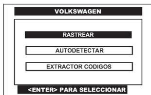
Pulse en la pantalla del CJ 4 R la opción de **RASTREAR** o selecciónela por medio de las teclas <ARRIBA> o <ABAJO> y presione la tecla <ENTER>.
