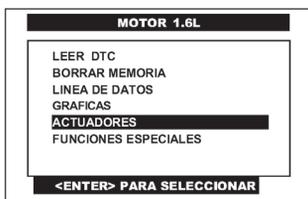
Pulse en la pantalla del CJ 4 R la opción **ACTUADORES** o selecciónela por medio de las teclas <ARRIBA> o <ABAJO> y presione la tecla <ENTER>.
