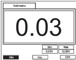
Esta función “congela” la lectura del voltímetro para su análisis, solo basta con presionar la tecla <ENTER>, ya que el botón de ALTO ya está preseleccionado de manera automática.
