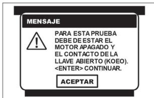
Para poder realizar esta función, verifique que el conmutador de encendido se encuentre en la posición de ON y el motor de encendido APAGADO (**KOE0**) y presione la tecla <ENTER>.
