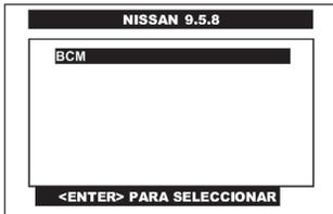
Pulse en la pantalla del CJ 4 R el sistema de **BCM** o selecciónelo por medio de las teclas <ARRIBA> o <ABAJO> y presione la tecla <ENTER>.
