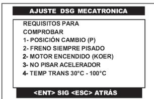
De igual manera, el CJ 4 R despliega las condiciones en las que se debe de hacer este ajuste. Una vez que se cumplen las condiciones, presione la tecla <ENTER> para continuar.
