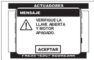
Al seleccionar el **ACTUADOR**, el CJ 4 R despliega una advertencia, donde se indica que la prueba solo se puede realizar con el conmutador de encendido en la posición de ON y el motor apagado (**KOEO**).
