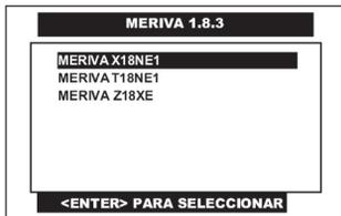
Pulse en la pantalla del CJ 4 R el tipo de **MOTOR** a utilizar o selecciónelo por medio de las teclas **<ARRIBA>** o **<ABAJO>** y presione la tecla **<ENTER>**.
