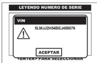
En el momento en el que el CJ 4 R obtiene el número de **VIN**, lo despliega en la pantalla. Pulse en la pantalla del CJ 4 R la opción de **<ACEPTAR>** o presione la tecla **<ENTER>** para continuar.
