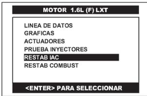
Del menú principal del sistema de motor y con el motor en ralentí, pulse en la pantalla del CJ 4 R la opción **RESTAB IAC** o selecciónela por medio de las teclas <ARRIBA> o <ABAJO> y presione la tecla <ENTER>.
