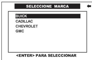
Pulse en la pantalla del CJ 4 R la **MARCA** a diagnosticar o selecciónela por medio de las teclas <ARRIBA> o <ABAJO> y presione la tecla <ENTER>.
