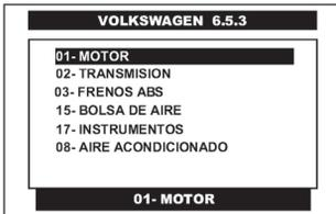
Pulse en la pantalla del CJ 4 R el sistema de **MOTOR** o selecciónelo por medio de las teclas <ARRIBA> o <ABAJO> y presione la tecla <ENTER>.
