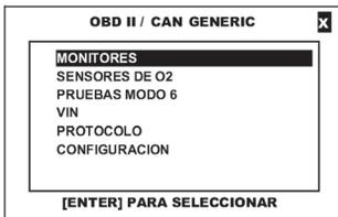
La disponibilidad de los monitores, depende del diseño del sistema de inyección del vehículo y del fabricante.
