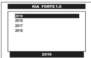
Pulse en la pantalla del CJ 4 R el **AÑO** del vehículo a diagnosticar o selecciónelo por medio de las teclas <ARRIBA> o <ABAJO> y presione la tecla <ENTER>.
