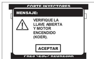
Al seleccionar el inyector a probar, el CJ 4 R despliega una advertencia, donde se indica que la prueba se debe de realizar con el conmutador de encendido en la posición de **ON** y el motor **encendido (KOER)**.
