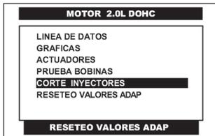
Del menú principal del sistema de motor pulse en la pantalla del CJ 4 R la opción **CORTE INYECTORES** o selecciónela por medio de las teclas <ARRIBA> o <ABAJO> y presione la tecla <ENTER>.
