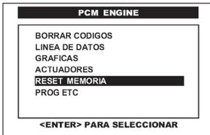
Del menú principal del sistema de **PCM** o **MOTOR** y con el conmutador de encendido en la posición de **ON** y el motor apagado (KOEO) pulse en la pantalla del CJ 4 R la opción **RESET MEMORIA** o selecciónela por medio de las teclas <ARRIBA> o <ABAJO> y presione la tecla <ENTER>.
