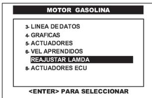
Del menú principal del sistema de motor, pulse en la pantalla del CJ 4 R la opción **REAJUSTAR LAMDA** o selecciónela por medio de las teclas <ARRIBA> o <ABAJO> y presione la tecla <ENTER>.
