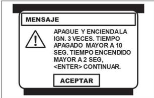
Como parte del procedimiento, el CJ 4 R solicita que se gire el conmutador de encendido a la posición de **OFF** y posteriormente a la posición de **ON tres veces**.
