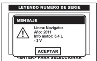
En el momento en el que el CJ 4 R **decodifica** el número de **VIN**, despliega en la pantalla la información. Pulse en la pantalla del CJ 4 R la opción de **<ACEPTAR>** o presione la tecla **<ENTER>** para continuar.
