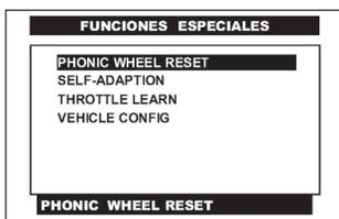
Del menú de **FUNCIONES ESPECIALES**, pulse en la pantalla del CJ 4 R la opción de **PHONIC WHEEL RESET** o selecciónela por medio de las teclas <ARRIBA> o <ABAJO> y presione la tecla <ENTER>.
