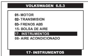
Pulse en la pantalla del CJ 4 R el sistema de **INSTRUMENTOS** o **INMOVILIZADOR** (según el sistema con el que cuente el vehículo) o selecciónelo por medio de las teclas <ARRIBA> o <ABAJO> y presione la tecla <ENTER>.
