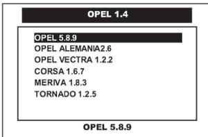
Pulse en la pantalla del CJ 4 R el **PROGRAMA** o el **TIPO** de vehículo a diagnosticar, o selecciónelo por medio de las teclas <ARRIBA> o <ABAJO> y presione la tecla <ENTER>.
