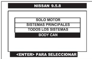
Del menú principal de **NISSAN 9.5.8**, pulse en la pantalla del CJ 4 R la opción **BODY CAN** o selecciónela por medio de las teclas <ARRIBA> o <ABAJO> y presione la tecla <ENTER>.
