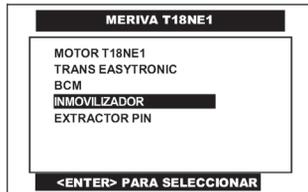
Pulse en la pantalla del CJ 4 R la opción de **INMOVILIZADOR** o selecciónela por medio de las teclas <ARRIBA> o <ABAJO> y presione la tecla <ENTER>.
