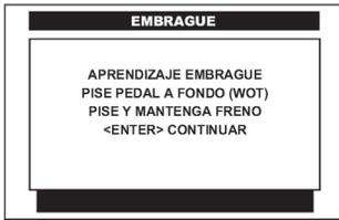
Pise a fondo el pedal del **acelerador (WOT)** el motor se va a mantener en promedio en **3000 rpm's**, manténgalo toda la prueba o hasta que el CJ 4 R indique lo contrario.
