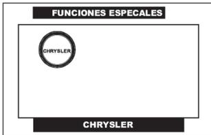
Con el conmutador de encendido en la posición de ON y el motor apagado (**KOEO**), pulse en la pantalla del CJ 4 R la opción **CHRYSLER** o selecciónela por medio de las teclas <ARRIBA> o <ABAJO> y presione la tecla <ENTER>.
