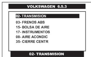
Pulse en la pantalla del CJ 4 R el sistema de **TRANSMISIÓN** o selecciónelo por medio de las teclas <ARRIBA> o <ABAJO> y presione la tecla <ENTER>.
