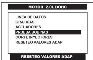
Del menú principal del sistema de motor pulse en la pantalla del CJ 4 R la opción **PRUEBA BOBINAS** o selecciónela por medio de las teclas <ARRIBA> o <ABAJO> y presione la tecla <ENTER>.
