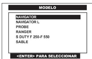
Pulse en la pantalla del CJ 4 R el **MODELO** del vehículo o selecciónelo por medio de las teclas <ARRIBA> o <ABAJO> y presione la tecla <ENTER>.
