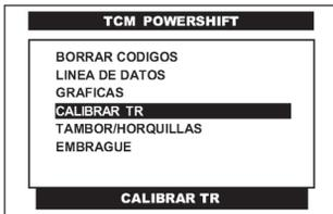
Pulse en la pantalla del CJ 4 R la opción **CALIBRAR TR** o selecciónela por medio de las teclas <ARRIBA> o <ABAJO> y presione la tecla <ENTER>.
