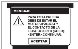
Para continuar, verifique que el conmutador de encendido se encuentre en la posición de ON y el motor de encendido APAGADO (**KOE0**), por medio de las teclas <ARRIBA> o <ABAJO> seleccione la opción de SI y presione la tecla <ENTER>.
