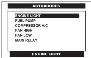
Pulse en la pantalla del CJ 4 R la opción del **actuador deseado** o selecciónela por medio de las teclas <ARRIBA> o <ABAJO> y presione la tecla <ENTER>.
