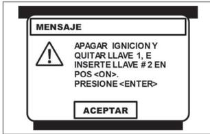
Retire llave uno e inserte llave dos, coloque el conmutador de encendido en la posición de "ON" y presione la tecla <ENTER>.
