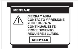
En ese momento el **CJ 4 R** solicita colocar el conmutador de encendido en la posición de **OFF** y posteriormente en la posición de **ON**, también nos recuerda que necesitamos **mínimo 2** llaves para realizar cualquier procedimiento.
