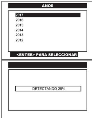
Pulse en la pantalla del CJ 4 R el **AÑO** o selecciónelo por medio de las teclas <ARRIBA> o <ABAJO> y presione la tecla <ENTER>.
