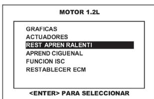
Del menú principal del sistema de motor y con el motor en ralentí, pulse en la pantalla del CJ 4 R la opción **REST APREN RALENTI** o selecciónela por medio de las teclas <ARRIBA> o <ABAJO> y presione la tecla <ENTER>.
