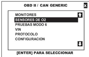
Para poder acceder a esta función, pulse la función "SENSORES DE O2" o selecciónela por medio de las teclas <ARRIBA> o <ABAJO> y presione la tecla <ENTER>.
