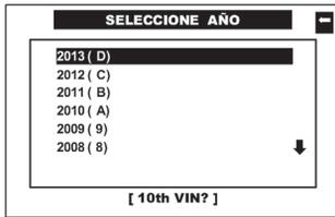
Pulse en la pantalla del CJ 4 R el **AÑO** del auto a diagnosticar, tomando en cuenta el 10° dígito del número de serie del vehículo o selecciónelo por medio de las teclas <ARRIBA> o <ABAJO> y presione la tecla <ENTER>.
