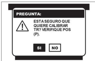
Confirmele al **CJ 4 R** que quieren **calibrar el TR** y que la palanca de cambios está en la posición de **Parking**.
