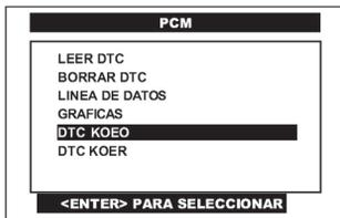
Pulse en la pantalla del CJ 4 R la opción de **DTC KOEO** o selecciónela por medio de las teclas <ARRIBA> ó <ABAJO> y presione la tecla <ENTER>.
