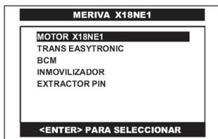
Pulse en la pantalla del CJ 4 R el **SISTEMA** a diagnosticar o selecciónelo por medio de las teclas <ARRIBA> o <ABAJO> y presione la tecla <ENTER>.
