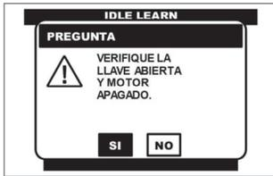
Para continuar, verifique que el conmutador de encendido se encuentre en la posición de ON y el motor de encuentre APAGADO (**KOEO**), por medio de las teclas <ARRIBA> o <ABAJO> seleccione la opción de SI y presione la tecla <ENTER>.
