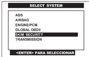
Del menú de seleccionar **SISTEMA**, con el conmutador de encendido en la posición de ON y el motor apagado (**KOEO**), pulse en la pantalla del CJ 4 R el sistema de **SKIME SECURITY** o selecciónelo por medio de las teclas <ARRIBA> o <ABAJO> y presione la tecla <ENTER>.
