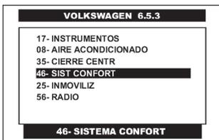
Pulse en la pantalla del CJ 4 R el sistema de **CONFORT** o **CIERRE CENTRALIZADO** (según el sistema con el que cuente el vehículo) o selecciónelo por medio de las teclas <ARRIBA> o <ABAJO> y presione la tecla <ENTER>.
