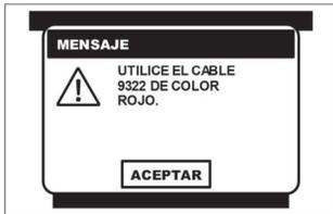
Al seleccionar la función de **CHRYSLER CAN**, el CJ 4 R despliega un mensaje, donde se indica que la prueba se debe de realizar con el cable 9322 de color rojo y con el conmutador de encendido en la posición de ON y el motor apagado (**KOEO**), presione la tecla <ENTER> para continuar.
