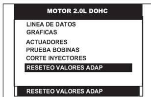
Del menú principal del sistema de motor pulse en la pantalla del CJ 4 R la opción **RESETEO VALORES ADAP** o selecciónela por medio de las teclas <ARRIBA> o <ABAJO> y presione la tecla <ENTER>.
