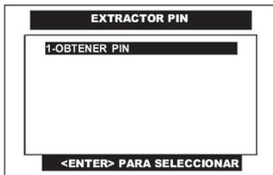
Pulse en la pantalla del CJ 4 R la función de **OBTENER PIN** o presione la tecla <ENTER>.
