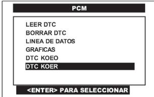
Pulse en la pantalla del CJ 4 R la opción de **DTC KOER** o selecciónela por medio de las teclas <ARRIBA> ó <ABAJO> y presione la tecla <ENTER>.
