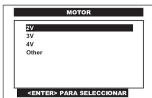
Pulse en la pantalla del CJ 4 R el **TIPO DE MOTOR** o selecciónelo por medio de las teclas <ARRIBA> o <ABAJO> y presione la tecla <ENTER>.
