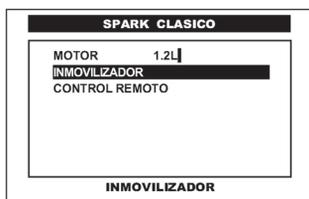
Del menú principal de los sistemas, pulse en la pantalla del CJ 4 R el sistema de **INMOVILIZADOR** o selecciónelo por medio de las teclas <ARRIBA> o <ABAJO> y presione la tecla <ENTER>.
