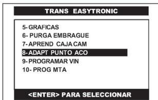
Del menú principal del sistema de TRANSMISION, pulse en la pantalla del CJ 4 R la opción **ADAPT PUNTO ACO** o selecciónela por medio de las teclas <ARRIBA> o <ABAJO> y presione la tecla <ENTER>.
