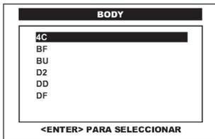
Pulse en la pantalla del CJ 4 R el **TIPO DE CARROCERÍA** del auto a diagnosticar o selecciónelo por medio de las teclas <ARRIBA> o <ABAJO> y presione la tecla <ENTER>.
