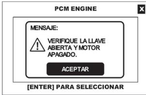
Al seleccionar la función de ACTUADORES, el CJ 4 R desplegará una advertencia, donde se indica que la prueba solo se puede realizar con el conmutador de encendido en la posición de ON y el motor apagado.
