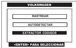
Pulse en la pantalla del CJ 4 R la opción de **EXTRACTOR CODIGOS** o selecciónela por medio de las teclas <ARRIBA> o <ABAJO> y presione la tecla <ENTER>.
