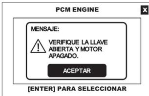
Al seleccionar la función de **RESET MEMORIA**, el CJ 4 R despliega una advertencia, donde se indica que la prueba solo se puede realizar con el conmutador de encendido en la posición de ON y el motor apagado (**KOEO**).
