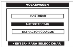
Pulse en la pantalla del CJ 4 R la opción de **AUTODETECTAR** o selecciónela por medio de las teclas <ARRIBA> o <ABAJO> y presione la tecla <ENTER>.
