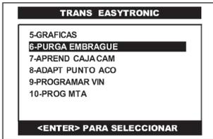
Del menú principal del sistema de TRANSMISION, pulse en la pantalla del CJ 4 R la opción **PURGA EMBRAGUE** o selecciónela por medio de las teclas <ARRIBA> o <ABAJO> y presione la tecla <ENTER>.
