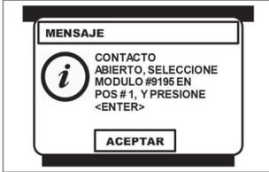
Al seleccionar la función de **CHRYSLER**, el CJ 4 R despliega una mensaje, donde se indica que la prueba solo se puede realizar con el conmutador de encendido en la posición de **ON** y el motor apagado (**KOEO**).
