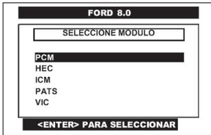
Pulse en la pantalla del CJ 4 R el tipo de **SISTEMA** al que se quiere ingresar (en este caso, es un vehículo con sistema PCM) o selecciónela por medio de las teclas <ARRIBA> o <ABAJO> y presione la tecla <ENTER>.
