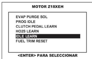
Del menú principal del sistema de motor y con el motor en ralentí, pulse en la pantalla del CJ 4 R la opción **IDLE LEARN** o selecciónela por medio de las teclas <ARRIBA> o <ABAJO> y presione la tecla <ENTER>.
