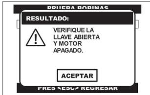
Al seleccionar la **bobina** a probar, el CJ 4 R despliega una advertencia, donde se indica que la prueba solo se puede realizar con el conmutador de encendido en la posición de **ON** y el **motor apagado (KOEO)**.
