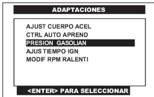
Pulse en la pantalla del CJ 4 R la opción **PRESION GASOLINA** o selecciónela por medio de las teclas <ARRIBA> o <ABAJO> y presione la tecla <ENTER>.
