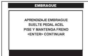
Suelte el pedal del **acelerador** y mantenga pisado el pedal del **freno**. Presione la tecla **<ENTER>** para continuar.
