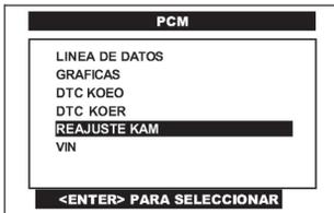
Pulse en la pantalla del CJ 4 R la opción de **REAJUSTE KAM** o selecciónela por medio de las teclas <ARRIBA> ó <ABAJO> y presione la tecla <ENTER>.
