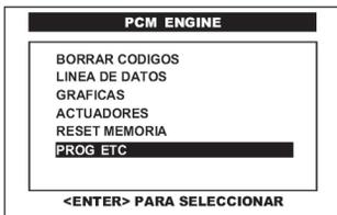
Del menú principal del sistema de **PCM** o **MOTOR** y con el conmutador de encendido en la posición de **ON** y el motor apagado (KOEO), pulse en la pantalla del CJ 4 R la opción **PROG ETC** o selecciónela por medio de las teclas <ARRIBA> o <ABAJO> y presione la tecla <ENTER>.
