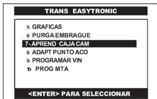
Del menú principal del sistema de TRANSMISION, pulse en la pantalla del CJ 4 R la opción **APREND CAJA CAM** o selecciónela por medio de las teclas <ARRIBA> o <ABAJO> y presione la tecla <ENTER>.
