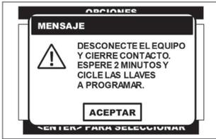
Una vez que se agregaron las llaves necesarias, el CJ 4 R solicita que se coloque conmutador de encendido en la posición de **OFF**, se retire la llave programada y se espere **2 minutos** para cerrar el ciclo de programación.
