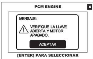
Al seleccionar la función de **ACTUADORES**, el CJ 4 R despliega una advertencia, donde se indica que la prueba solo se puede realizar con el conmutador de encendido en la posición de ON y el motor apagado (**KOEO**).
