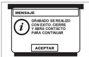
En ese momento el CJ 4 R mostrara un **mensaje de confirmación**, donde indica la modificación correcta del **VIN** y solicita que se coloque el conmutador de encendido en la posición de **OFF** y posteriormente en la posición de **ON**.
