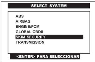
Del menú de seleccionar **SISTEMA**, con el conmutador de encendido en la posición de ON y el motor apagado (**KOEO**), pulse en la pantalla del CJ 4 R el sistema de **SKIME SECURITY** o selecciónelo por medio de las teclas <ARRIBA> o <ABAJO> y presione la tecla <ENTER>.
