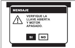
Al seleccionar esta función, el CJ 4 R despliega un mensaje donde se indica que la prueba solo se puede realizar con el conmutador de encendido en la posición de ON y el motor apagado (**KOEO**).
