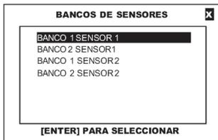
Posterior a la verificación por parte del CJ 4 R, seleccione el banco y el sensor a verificar pulsándolo en la pantalla o utilice las teclas <ARRIBA> o <ABAJO> y presione la tecla <ENTER>.
