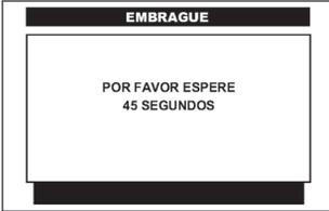
Para poder terminar con el aprendizaje, el **CJ 4 R** solicita que el **conmutador** de **encendido** este en la posición de **OFF** durante 45 segundos.
