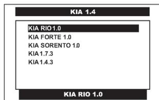
Pulse en la pantalla del CJ 4 R el **MODELO** a utilizar o selecciónelo por medio de las teclas <ARRIBA> o <ABAJO> y presione la tecla <ENTER>.
