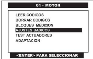
Pulse en la pantalla del CJ 4 R la opción de **AJUSTES BASICOS** o selecciónela por medio de las teclas <ARRIBA> o <ABAJO> y presione la tecla <ENTER>.
