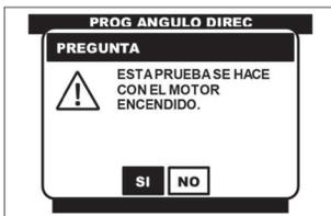
El sistema de la dirección asistida, solicita que esta prueba se haga con el **motor encendido**, por medio de las flechas <IZQUIERDA> O <DERECHA> seleccione la opción de **SI** y presione la tecla <ENTER>.
