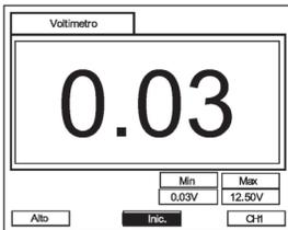
Esta función sirve para reiniciar a cero los valores de las casillas MINIMO y MAXIMO, estas casillas nos indican el valor mínimo y máximo medido por el voltímetro durante la medición.
