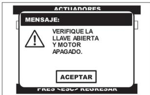
Al seleccionar la **actuador** a probar, el CJ 4 R despliega una advertencia, donde se indica que la prueba solo se puede realizar con el conmutador de encendido en la posición de **ON** y el **motor apagado (KOE0)**.
