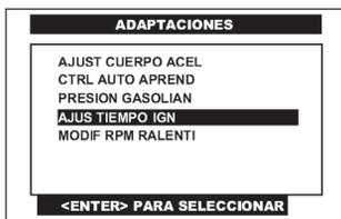
Pulse en la pantalla del CJ 4 R la opción **AJUS TIEMPO IGN** o selecciónela por medio de las teclas <ARRIBA> o <ABAJO> y presione la tecla <ENTER>.
