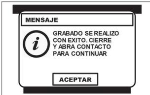
En ese momento el CJ 4 R mostrará un **mensaje de confirmación**, donde indica la modificación correcta del **VIN** y solicita que se coloque el conmutador de encendido en la posición de **OFF** y posteriormente en la posición de **ON**.
