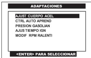
Pulse en la pantalla del CJ 4 R la opción **AJUST CUERPO ACEL** o selecciónela por medio de las teclas <ARRIBA> o <ABAJO> y presione la tecla <ENTER>.
