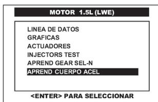
Del menú principal del sistema de motor, con el motor apagado y el conmutador de encendido en la posición de ON (KOEO), pulse en la pantalla del CJ 4 R la opción **APREND CUERPO ACEL** o selecciónela por medio de las teclas <ARRIBA> o <ABAJO> y presione la tecla <ENTER>.
