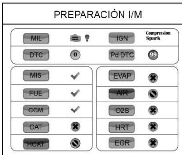
Figure 4-31 Muestra de la Pantalla de Preparación I/M
