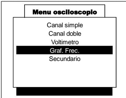
Para poder acceder a esta función, seleccione la función GRAFICA FRECUENCIA por medio de las teclas <ARRIBA> o <ABAJO> y presione la tecla <ENTER>.
