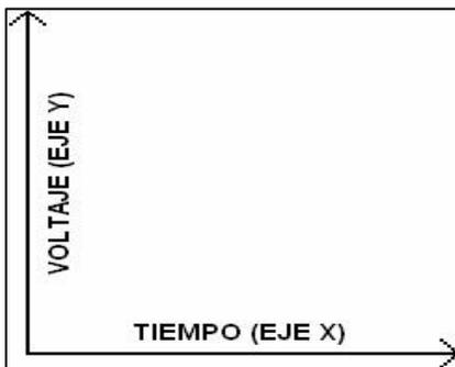
A grandes rasgos, el funcionamiento del osciloscopio es muy sencillo, este grafica el comportamiento de voltaje con relación al tiempo.
