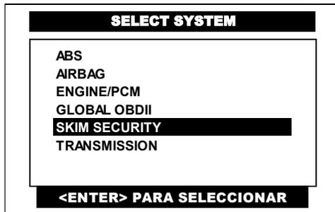
Del menú de seleccionar **SISTEMA**, con el conmutador de encendido en la posición de ON y el motor apagado (**KOEO**), pulse en la pantalla del CJ 7 S el sistema de **SKIME SECURITY** o selecciónelo por medio de las teclas <ARRIBA> o <ABAJO> y presione la tecla <ENTER>.
