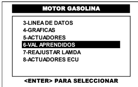
Del menú principal del sistema de motor y con el motor en ralentí, pulse en la pantalla del CJ 7 S la opción **VAL APRENDIDOS** o selecciónela por medio de las teclas <ARRIBA> o <ABAJO> y presione la tecla <ENTER>.
