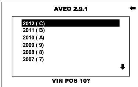
Pulse en la pantalla del CJ 7 S el **AÑO** del vehículo a diagnosticar, tomando en cuenta el 10º dígito del número de serie del vehículo o selecciónelo por medio de las teclas <ARRIBA> o <ABAJO> y presione la tecla <ENTER>.
