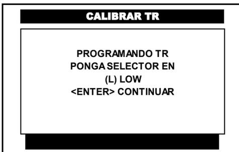
Coloque la palanca en la posición de **LOW** y presione la tecla <ENTER> para que aprenda la posición.
