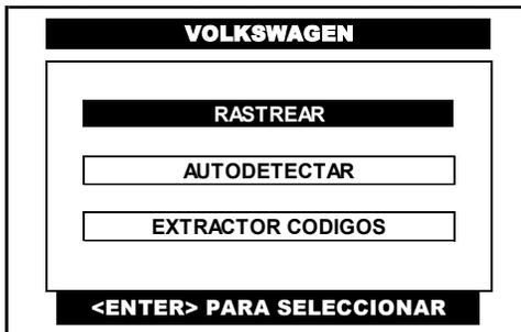
Pulse en la pantalla del CJ 7 S la opción de **RASTREAR** o selecciónela por medio de las teclas <ARRIBA> o <ABAJO> y presione la tecla <ENTER>.
