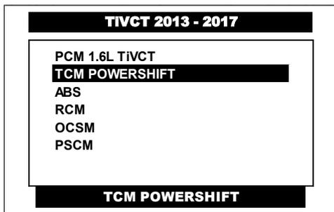
Pulse en la pantalla del CJ 7 S el **SISTEMA de TCM POWERSHIFT** o selecciónelo por medio de las teclas <ARRIBA> o <ABAJO> y presione la tecla <ENTER>.
