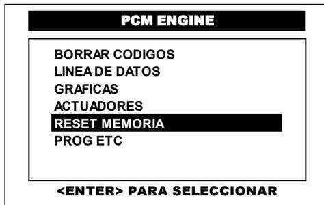
Del menú principal del sistema de **PCM** o **MOTOR** y con el conmutador de encendido en la posición de **ON** y el motor apagado (KOEO) pulse en la pantalla del CJ 7 S la opción **RESET MEMORIA** o selecciónela por medio de las teclas <ARRIBA> o <ABAJO> y presione la tecla <ENTER>.
