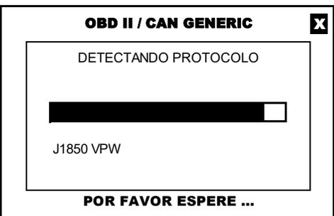
Una vez iniciada la búsqueda del protocolo, EL **CJ 7 S** mostrará una pantalla en la cual se visualizara una barra horizontal que se irá completando conforme busque el **protocolo** de diagnóstico.
