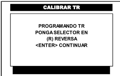
Coloque la palanca en la posición de **REVERSA** y presione la tecla <ENTER> para que aprenda la posición.
