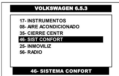
Pulse en la pantalla del CJ 7 S el sistema de **CONFORT** o **CIERRE CENTRALIZADO** (según el sistema con el que cuente el vehículo) o selecciónelo por medio de las teclas <ARRIBA> o <ABAJO> y presione la tecla <ENTER>.
