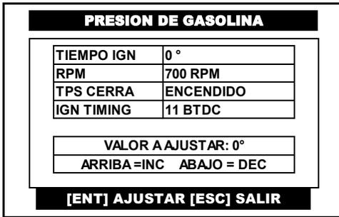
Por medio de las flechas <ARRIBA> o <ABAJO> **agregue o quite** grados al **tiempo de encendido**, una vez que se logró el valor deseado, presione la tecla <ENTER> para ajustar y fijar el nuevo tiempo de encendido.
