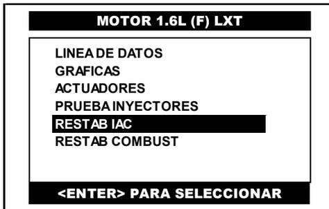
Del menú principal del sistema de motor y con el motor en ralentí, pulse en la pantalla del CJ 7 S la opción **RESTAB IAC** o selecciónela por medio de las teclas <ARRIBA> o <ABAJO> y presione la tecla <ENTER>.
