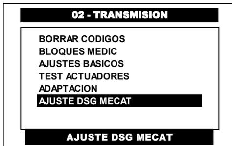
Pulse en la pantalla del CJ 7 S la función de **AJUSTE DSG MECATR** o selecciónela por medio de las teclas <ARRIBA> o <ABAJO> y presione la tecla <ENTER>.
