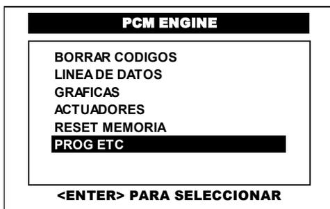
Del menú principal del sistema de **PCM** o **MOTOR** y con el conmutador de encendido en la posición de **ON** y el motor apagado (KOEO), pulse en la pantalla del CJ 7 S la opción **PROG ETC** o selecciónela por medio de las teclas <ARRIBA> o <ABAJO> y presione la tecla <ENTER>.
