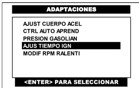
Pulse en la pantalla del CJ 7 S la opción **AJUS TIEMPO IGN** o selecciónela por medio de las teclas <ARRIBA> o <ABAJO> y presione la tecla <ENTER>.
