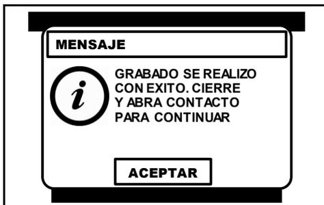
En ese momento el CJ 7 S mostrara un **mensaje de confirmación**, donde indica la modificación correcta del **VIN** y solicita que se coloque el conmutador de encendido en la posición de **OFF** y posteriormente en la posición de **ON**.
