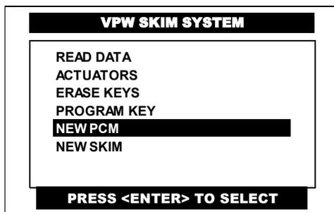
Pulse en la pantalla del CJ 7 S la función de **NEW PCM** o selecciónela por medio de las teclas <ARRIBA> o <ABAJO> y presione la tecla <ENTER>.
