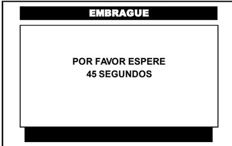
Para poder terminar con el aprendizaje, el **CJ 7 S** solicita que el **conmutador de encendido** este en la posición de **OFF** durante 45 segundos.
