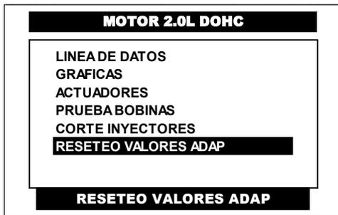
Del menú principal del sistema de motor pulse en la pantalla del CJ 7 S la opción **RESETEO VALORES ADAP** o selecciónela por medio de las teclas <ARRIBA> o <ABAJO> y presione la tecla <ENTER>.
