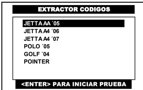
Pulse en la pantalla del CJ 7 S el **MODELO** del auto o selecciónelo por medio de las teclas <ARRIBA> o <ABAJO> y presione la tecla <ENTER>.
