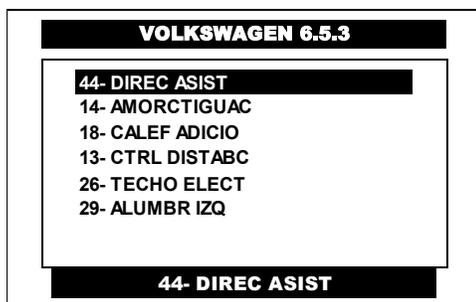
Pulse en la pantalla del CJ 7 S el sistema de **DIRECCION ASISTIDA** o selecciónelo por medio de las teclas <ARRIBA> o <ABAJO> y presione la tecla <ENTER>.
