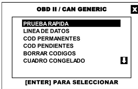
El **CJ 7 S** integra esta prueba que permite un diagnóstico a todo el sistema de inyección en unos cuantos segundos, este tipo de diagnóstico es muy conveniente para realizar a aquellas unidades en las cuales solo se les hace un mantenimiento rutinario, o bien a vehículos a los cuales se les realiza como un extra, es decir, una revisión al vehículo con muy poca inversión en mano de obra y prácticamente sin costo.
