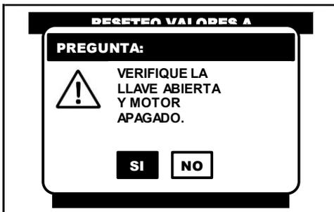
Al seleccionar la función de RESETEO VALORES ADAP, el CJ 7 S despliega una advertencia, donde se indica que la prueba solo se puede realizar con el conmutador de encendido en la posición de ON y el motor apagado (**KOEO**).
