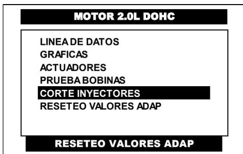
Del menú principal del sistema de motor pulse en la pantalla del CJ 7 S la opción **CORTE INYECTORES** o selecciónela por medio de las teclas <ARRIBA> o <ABAJO> y presione la tecla <ENTER>.
