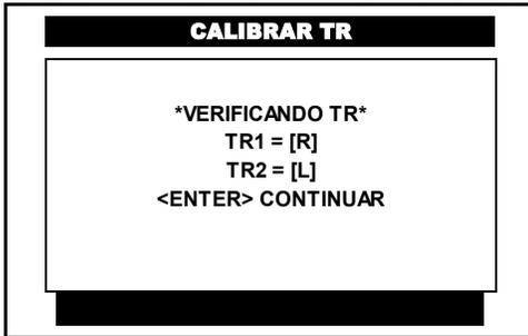
Al terminar de aprender todas las **posiciones** de la **palanca**, la unidad de control comprueba y verifica los motores de accionamiento, una vez que termine, presione la tecla **<ENTER>** para continuar.
