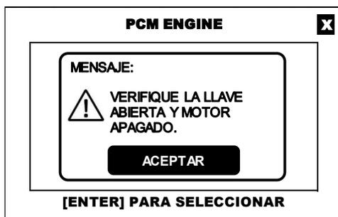
Al seleccionar la función de ACTUADORES, el CJ 7 S desplegará una advertencia, donde se indica que la prueba solo se puede realizar con el conmutador de encendido en la posición de ON y el motor apagado.
