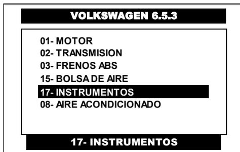
Pulse en la pantalla del CJ 7 S el sistema de **INSTRUMENTOS** o **INMOVILIZADOR** (según el sistema con el que cuente el vehículo) o selecciónelo por medio de las teclas <ARRIBA> o <ABAJO> y presione la tecla <ENTER>.
