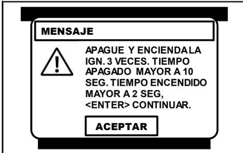
Como parte del procedimiento, el CJ 7 S solicita que se gire el conmutador de encendido a la posición de **OFF** y posteriormente a la posición de **ON tres veces**.
