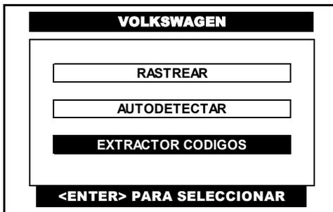
Pulse en la pantalla del CJ 7 S la opción de **EXTRACTOR CODIGOS** o selecciónela por medio de las teclas <ARRIBA> o <ABAJO> y presione la tecla <ENTER>.
