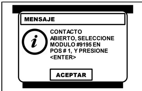
Al seleccionar la función de **CHRYSLER**, el CJ 7 S despliega una mensaje, donde se indica que la prueba solo se puede realizar con el conmutador de encendido en la posición de ON y el motor apagado (**KOEO**).
