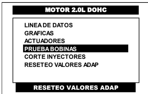
Del menú principal del sistema de motor pulse en la pantalla del CJ 7 S la opción **PRUEBA BOBINAS** o selecciónela por medio de las teclas <ARRIBA> o <ABAJO> y presione la tecla <ENTER>.
