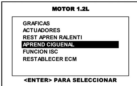
Del menú principal del sistema de motor y con el motor en ralentí, pulse en la pantalla del CJ 7 S la opción **APRENDIZAJE CIGÜEÑAL** o selecciónela por medio de las teclas <ARRIBA> o <ABAJO> y presione la tecla <ENTER>.
