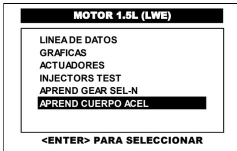
Del menú principal del sistema de motor, con el motor apagado y el conmutador de encendido en la posición de ON (**KOEO**), pulse en la pantalla del CJ 7 S la opción **APREND CUERPO ACEL** o selecciónela por medio de las teclas <ARRIBA> o <ABAJO> y presione la tecla <ENTER>.
