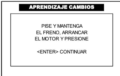
Al terminar de engranar las velocidades, se requiere sincronizar los cambios con respecto al punto de acoplamiento, el CJ 7 S solicitará **pisar y mantener el pedal del freno y arrancar el motor**. Cuando se cumplan los requisitos presione la tecla <ENTER> para continuar.
