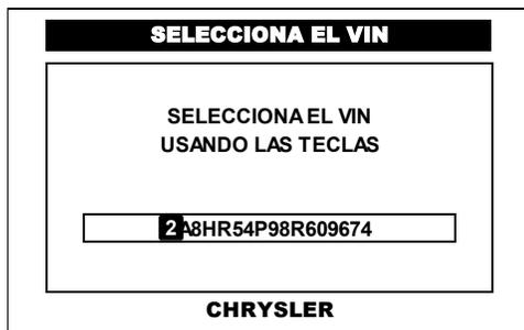
Una vez que el CJ 7 S realiza la conexión correcta y localiza la ubicación electrónica del **VIN** permite la modificación del mismo.
