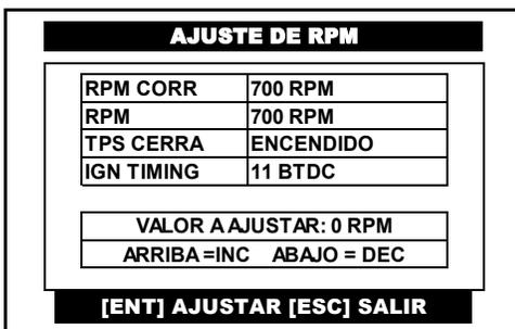
Por medio de las flechas <ARRIBA> o <ABAJO> **agregue o quite revoluciones** al ralentí, una vez que se logró el valor deseado, presione la tecla <ENTER> para ajustar y fijar el nuevo valor.
