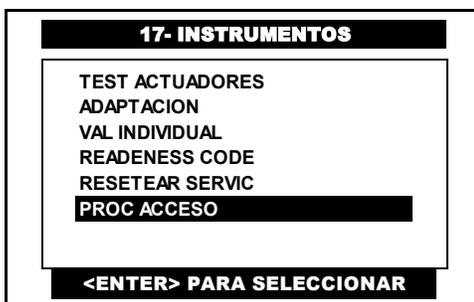
Pulse en la pantalla del CJ 7 S la opción de **PROC ACCESO** o selecciónela por medio de las teclas <ARRIBA> o <ABAJO> y presione la tecla <ENTER>.
