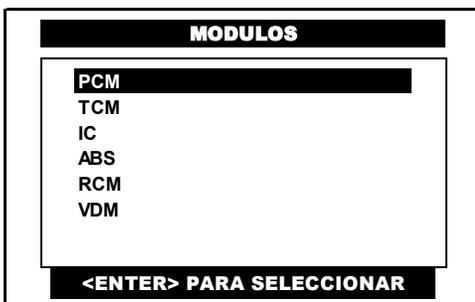
Posterior a eso, y después de comunicar con el BCM, el CJ 7 S despliega en la pantalla los **SISTEMAS** disponibles para el vehículo.
