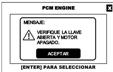
Al seleccionar la función de **RESET MEMORIA**, el CJ 7 S despliega una advertencia, donde se indica que la prueba solo se puede realizar con el conmutador de encendido en la posición de ON y el motor apagado (**KOEO**).
