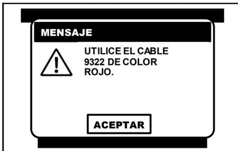
Al seleccionar la función de **CHRYSLER CAN**, el CJ 7 S despliega un mensaje, donde se indica que la prueba se debe de realizar con el cable 9322 de color rojo y con el conmutador de encendido en la posición de ON y el motor apagado (**KOEO**), presione la tecla <ENTER> para continuar.
