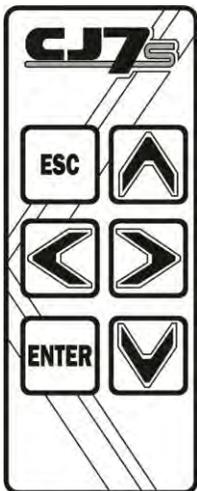
El CJ 7 S cuenta con 2 teclados y estos consisten de 10 interruptores tipo membrana, diseñados para una fácil activación.
