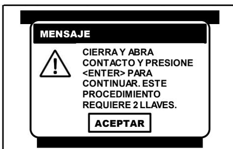
En ese momento el **CJ 7 S** solicita colocar el conmutador de encendido en la posición de **OFF** y posteriormente en la posición de **ON**, también nos recuerda que necesitamos **mínimo 2** llaves para realizar cualquier procedimiento.
