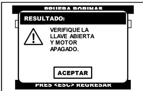
Al seleccionar la **bobina** a probar, el CJ 7 S despliega una advertencia, donde se indica que la prueba solo se puede realizar con el conmutador de encendido en la posición de **ON** y el **motor apagado (KOEO)**.
