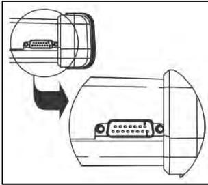
Conecte el cable 9322 de color rojo al CJ 7 S conectándolo primero al puerto DB – 26 (que está localizado en la parte superior derecha del CJ 7 S), verifique que asiente correctamente y asegure firmemente los tornillos del cable.
