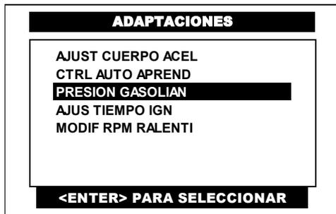
Pulse en la pantalla del CJ 7 S la opción **PRESION GASOLINA** o selecciónela por medio de las teclas <ARRIBA> o <ABAJO> y presione la tecla <ENTER>.
