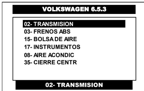
Pulse en la pantalla del CJ 7 S el sistema de **TRANSMISIÓN** o selecciónelo por medio de las teclas <ARRIBA> o <ABAJO> y presione la tecla <ENTER>.
