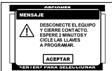
Una vez que se agregaron las llaves necesarias, el CJ 7 S solicita que se coloque **conmutador de encendido** en la posición de **OFF**, se retire la llave programada y se espere **2 minutos** para cerrar el ciclo de programación.
