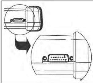
Conecte el cable 9322 de color rojo al CJ 7 S (o el cable que le solicite el equipo) conectándolo primero al puerto DB – 26 (que está localizado en la parte superior derecha del CJ 7 S), verifique que asiente correctamente y asegure firmemente los tornillos del cable.
