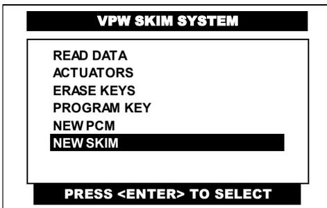
Pulse en la pantalla del CJ 7 S la función de **NEW SKIM** o selecciónela por medio de las teclas <ARRIBA> o <ABAJO> y presione la tecla <ENTER>.
