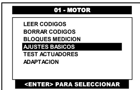
Pulse en la pantalla del CJ 7 S la opción de **AJUSTES BASICOS** o selecciónela por medio de las teclas <ARRIBA> o <ABAJO> y presione la tecla <ENTER>.
