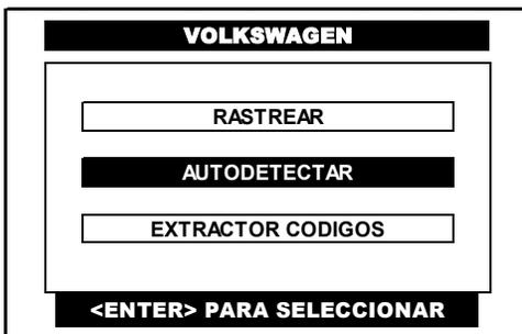
Pulse en la pantalla del CJ 7 S la opción de **AUTODETECTAR** o selecciónela por medio de las teclas <ARRIBA> o <ABAJO> y presione la tecla <ENTER>.
