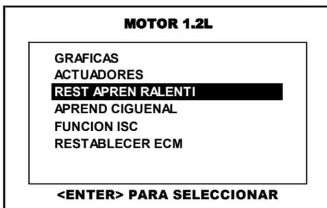
Del menú principal del sistema de motor y con el motor en ralenti, pulse en la pantalla del CJ 7 S la opción **REST APREND RALENTI** o selecciónela por medio de las teclas <ARRIBA> o <ABAJO> y presione la tecla <ENTER>.
