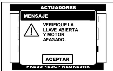
Al seleccionar el **ACTUADOR**, el CJ 7 S despliega una advertencia, donde se indica que la prueba solo se puede realizar con el conmutador de encendido en la posición de ON y el motor apagado (**KOEO**).
