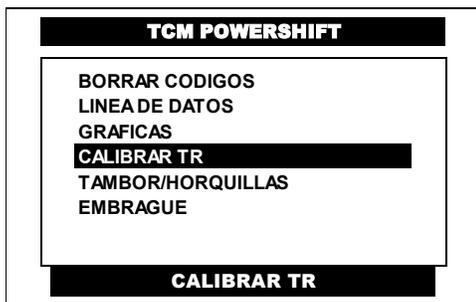
Pulse en la pantalla del CJ 7 S la opción **CALIBRAR TR** o selecciónela por medio de las teclas <ARRIBA> o <ABAJO> y presione la tecla <ENTER>.
