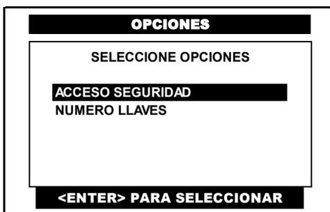
Pulse en la pantalla del CJ 7 S la opción de **ACCESO DE SEGURIDAD** o selecciónela por medio de las teclas <ARRIBA> o <ABAJO> y presione la tecla <ENTER>.
