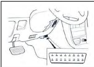
Localice el conector de diagnóstico en el automóvil, comúnmente localizado en la parte inferior del tablero de instrumentos o bien, consulte el manual de servicio del vehículo para su ubicación.
