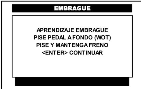
Pise a fondo el pedal del **acelerador (WOT)** el motor se va a mantener en promedio en **3000** rpm's, manténgalo toda la prueba o hasta que el CJ 7 S indique lo contrario.
