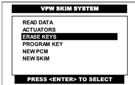
Pulse en la pantalla del CJ 7 S la función de **ERASE KEYS** o selecciónela por medio de las teclas <ARRIBA> o <ABAJO> y presione la tecla <ENTER>.
