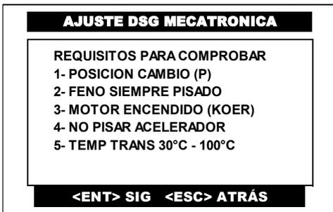
De igual manera, el CJ 7 S despliega las condiciones en las que se debe de hacer este ajuste.
