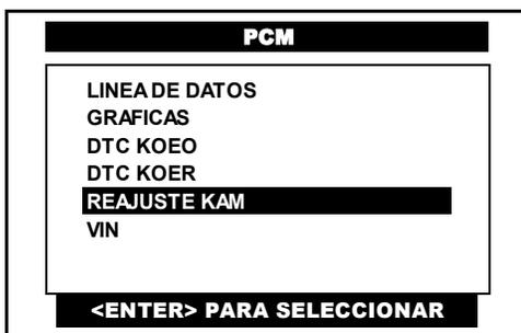
Pulse en la pantalla del CJ 7 S la opción de **REAJUSTE KAM** o selecciónela por medio de las teclas <ARRIBA> ó <ABAJO> y presione la tecla <ENTER>.
