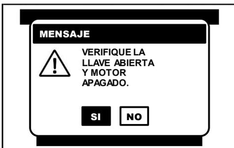
Al seleccionar esta función, el CJ 7 S despliega un mensaje donde se indica que la prueba solo se puede realizar con el conmutador de encendido en la posición de ON y el motor apagado (**KOEO**).
