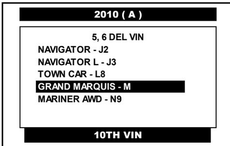
Pulse en la pantalla del CJ 7 S el **TIPO** de auto a diagnosticar, tomando en cuenta el **5° y 6° dígito** del número de serie del vehículo o selecciónelo por medio de las teclas <ARRIBA> o <ABAJO> y presione la tecla <ENTER>.
