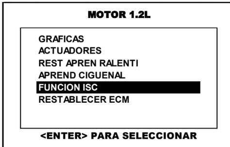
Del menú principal del sistema de motor y con el motor en ralentí, pulse en la pantalla del CJ 7 S la opción **FUNCION ISC** o selecciónela por medio de las teclas <ARRIBA> o <ABAJO> y presione la tecla <ENTER>.
