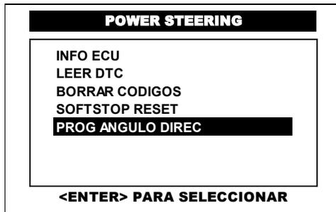
Del menú principal del sistema de la dirección asistida (**POWER STEERING**), pulse en la pantalla del CJ 7 S la opción **PROG ANGULO DIREC** o selecciónela por medio de las teclas <ARRIBA> o <ABAJO> y presione la tecla <ENTER>.
