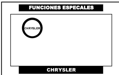
Con el conmutador de encendido en la posición de ON y el motor apagado (**KOEO**), pulse en la pantalla del CJ 7 S la opción **CHRYSLER** o selecciónela por medio de las teclas <ARRIBA> o <ABAJO> y presione la tecla <ENTER>.
