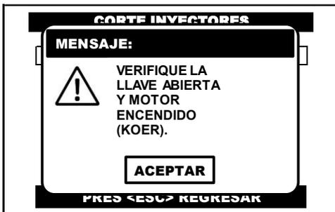
Al seleccionar el inyector a probar, el CJ 7 S despliega una advertencia, donde se indica que la prueba se debe de realizar con el conmutador de encendido en la posición de **ON** y el motor **encendido (KOER)**.
