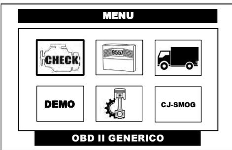
Pulse en la pantalla del CJ 7 S la opción de **OBD II GENÉRICO** o selecciónela por medio de las teclas <ARRIBA> o <ABAJO> y presione la tecla <ENTER>.
