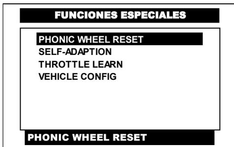
Del menú de **FUNCIONES ESPECIALES**, pulse en la pantalla del CJ 7 S la opción de **PHONIC WHEEL RESET** o selecciónela por medio de las teclas <ARRIBA> o <ABAJO> y presione la tecla <ENTER>.
