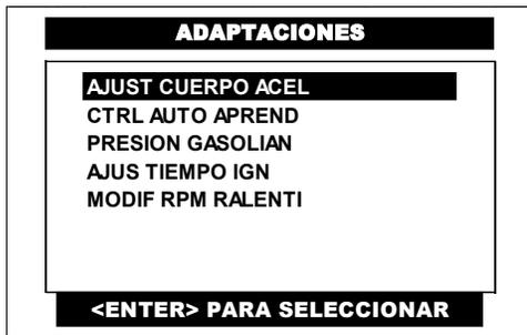
Pulse en la pantalla del CJ 7 S la opción **AJUST CUERPO ACEL** o selecciónela por medio de las teclas <ARRIBA> o <ABAJO> y presione la tecla <ENTER>.
