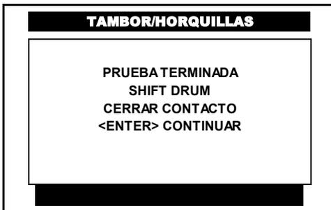
Al terminar la prueba **SHIFT DRUM**, el CJ7 S solicita colocar el **conmutador de encendido** en la posición de **OFF** y posterior a eso, presionar la tecla <ENTER> para continuar.
