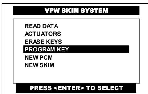
Pulse en la pantalla del CJ 7 S la función de **PROGRAM KEY** o selecciónela por medio de las teclas <ARRIBA> o <ABAJO> y presione la tecla <ENTER>.
