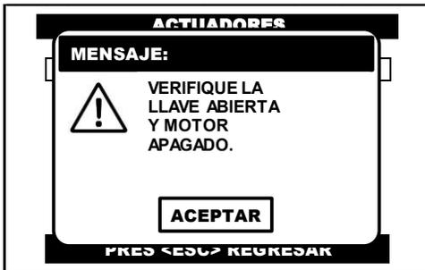
Al seleccionar la **actuador** a probar, el CJ 7 S despliega una advertencia, donde se indica que la prueba solo se puede realizar con el conmutador de encendido en la posición de **ON** y el **motor apagado (KOE0)**.
