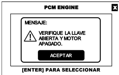
Al seleccionar la función de **ACTUADORES**, el CJ 7 S despliega una advertencia, donde se indica que la prueba solo se puede realizar con el conmutador de encendido en la posición de ON y el motor apagado (**KOEO**).
