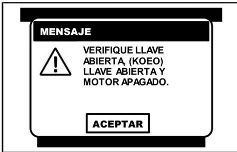
Al seleccionar cualquiera de las **FUNCIONES ESPECIALES**, el CJ 7 S despliega un mensaje, donde se indica que la prueba solo se puede realizar con el conmutador de encendido en la posición de ON y el motor apagado (**KOEO**).
