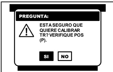
Confirmele al **CJ 7 S** que quieren **calibrar el TR** y que la palanca de cambios está en la posición de **Parking**.
