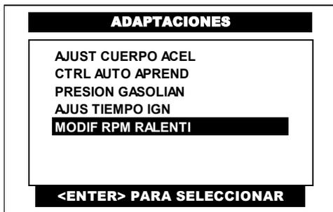
Pulse en la pantalla del CJ 7 S la opción **MODIF RPM RALENTI** o selecciónela por medio de las teclas <ARRIBA> o <ABAJO> y presione la tecla <ENTER >.
