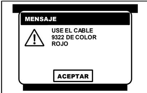
Para **acceder al sistema** del inmovilizador, el CJ 7 S solicita el cable **9322 de color rojo**, una vez colocado presione la tecla <ENTER> para continuar.
