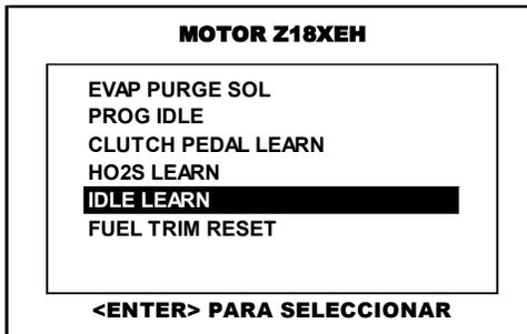
Del menú principal del sistema de motor y con el motor en ralentí, pulse en la pantalla del CJ 7 S la opción **IDLE LEARN** o selecciónela por medio de las teclas <ARRIBA> o <ABAJO> y presione la tecla <ENTER>.
