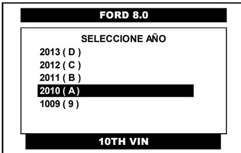
Pulse en la pantalla del CJ 7 S el **AÑO** del auto a diagnosticar, tomando en cuenta el **10° dígito** del número de serie del vehículo o selecciónelo por medio de las teclas <ARRIBA> o <ABAJO> y presione la tecla <ENTER>.
