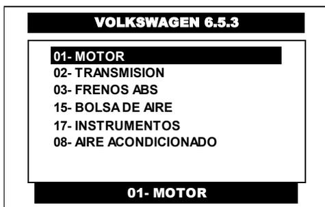
Pulse en la pantalla del CJ 7 S el sistema de **MOTOR** o selecciónelo por medio de las teclas <ARRIBA> o <ABAJO> y presione la tecla <ENTER>.
