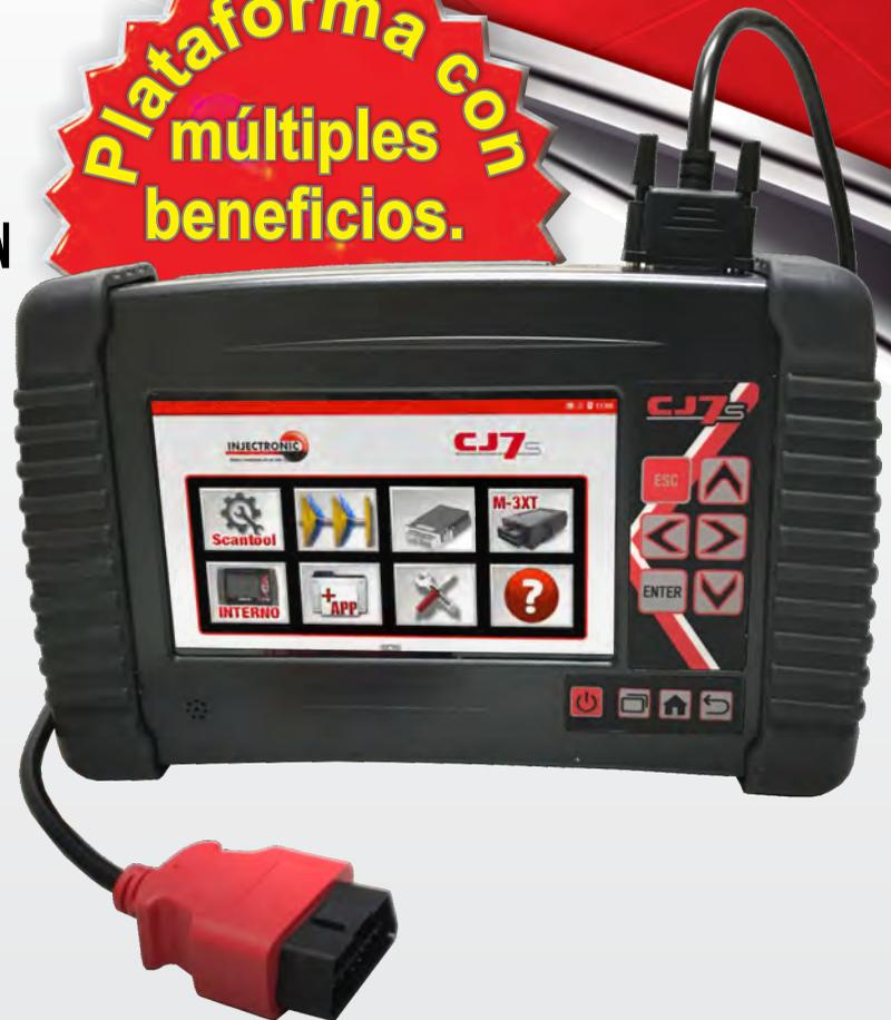
Los módulos VCM (Vehicle Communication Module) tienen la capacidad de funcionar como módulos de protocolos OBD-2, reprogramadores J2534, osciloscopios y unidades de almacenamiento, entre otros.
